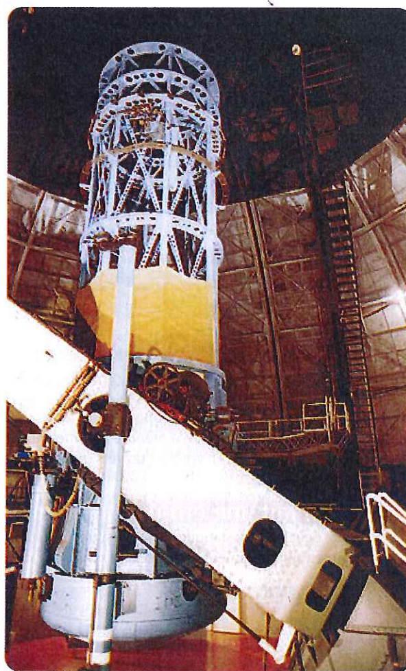
Le télescope Hooker sur le mont Wilson, le plus grand du monde en 1920, avec lequel Humason et Hubble ont mesuré les distances et les décalages spectraux des galaxies.
